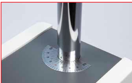
▲ Die Anwinkelung der Paneele ist durch die Skala im Sockel gradgenau reproduzierbar.
