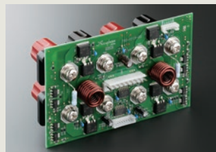
Schutzschaltungen mit MOS-FET-Schaltern
